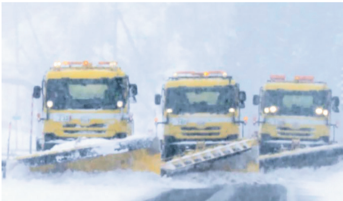
写真 梯団走行による除雪作業
